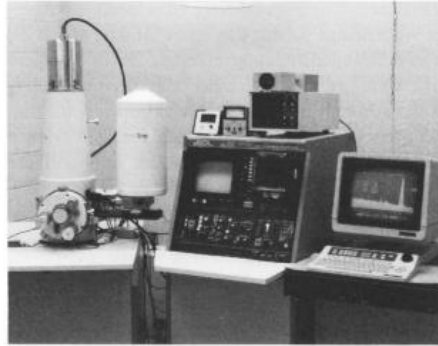
Abbildung 4.371: EDS-System angeschlossen an ein REM
