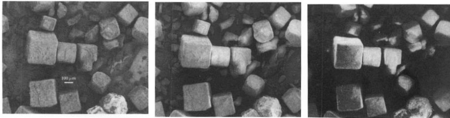
Abbildung 4.367: Abbildung von Salz bei verschiedenen Beschleunigungsspannungen (von links: 1 kV, 5kV, 15kV).
