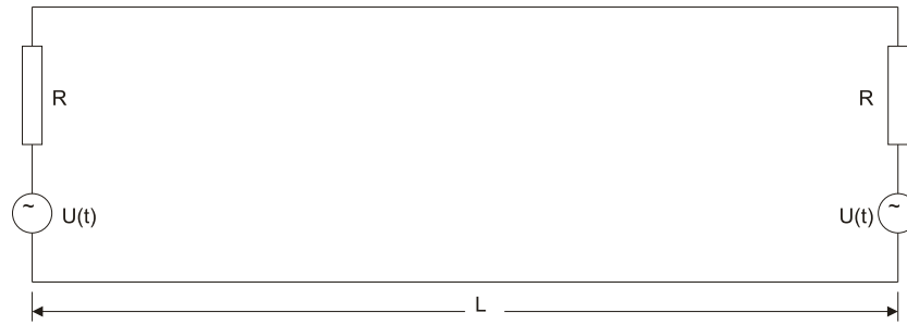
Abbildung 2.70: Nyquists Anordnung zur Berechnung der Rauschspannung an einem Widerstand
