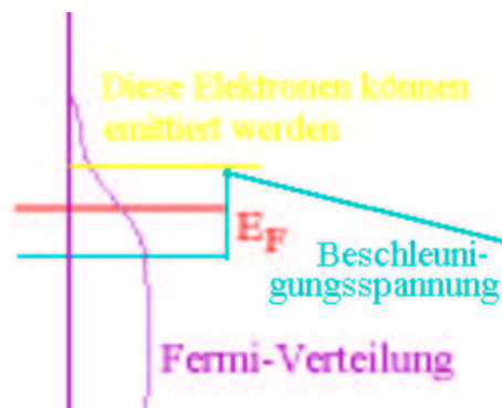
Abbildung 4.330: Energieverhältnisse an der Oberfläche einer Elektrode
