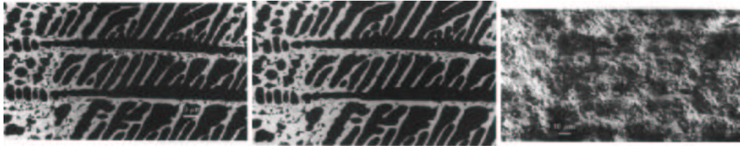
Abbildung 4.345: Vergleich der REM-Bilder als Funktion der Oberflächenbeschaffenheit. Links ist ein Sekundärelektronenbild der polierten Oberfläche einer antiken griechischen Münze. In der Mitte befindet sich das Rückstreubild, während rechts ein Sekundärelektronenbild einer Bruchfläche gezeigt ist.
