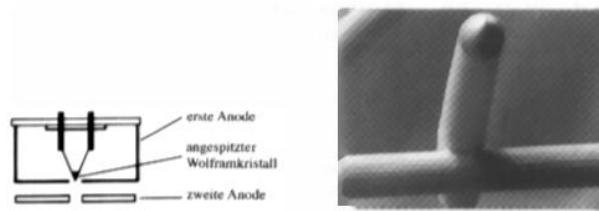
Abbildung 4.329: Bild einer Feldemissionskathode. Dabei wird, analog zu einem STM, eine zugespitzte Wolframnadel als Emitter verwendet.
