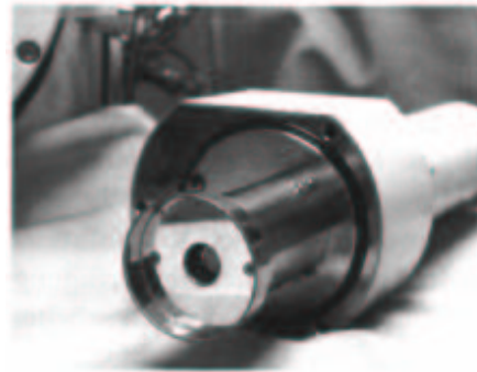
Abbildung 4.333: Everhart-Thornley-Detektor. Die ringförmige Struktur aussen ist der Faraday-Käfig, hinten befindet sich der Szintillator-Kristall
